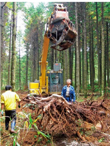
北海道の演習林でドマツの根系の重量を計測
