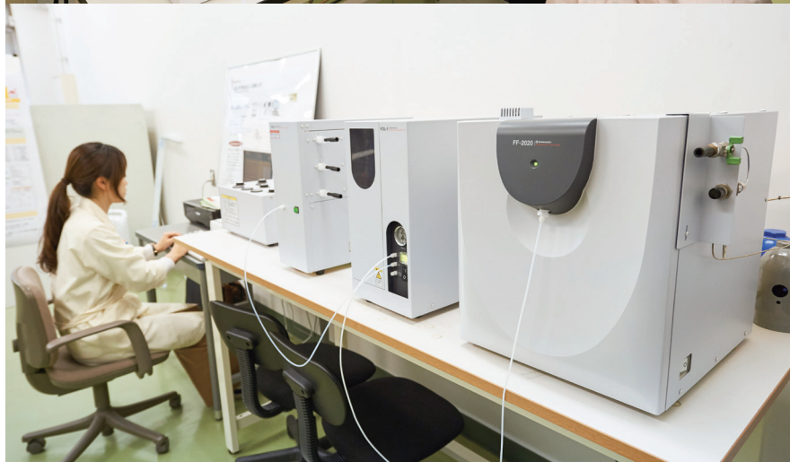
▲写真上:「におい嗅ぎGC-MS」では分離された成分を直接鼻で嗅ぎ、評価ができる 写真下:パンや味噌など、私たちになじみ深い食品も供試される「におい識別装置」
