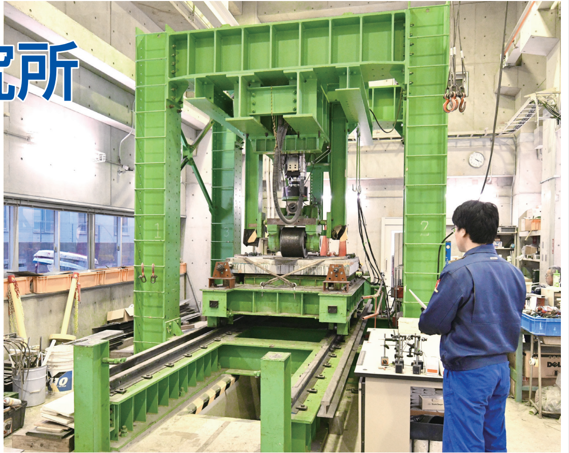
▲(上左)生産工学研究所32号館(上右)38号館(下)三次元人体動作計測・筋骨格モデル動作解析システムの操作 ▲走行振動試験装置で橋の床版の疲労実験中
