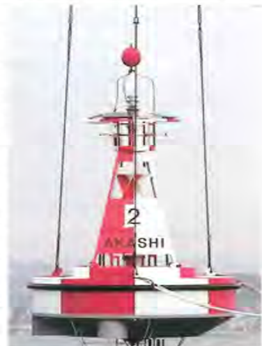
潮流発電システムを装備した灯浮標
