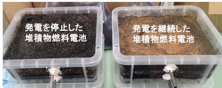
図2 下水汚泥をろ過濃縮する堆積物燃料電池の外観
