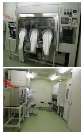
図3. アイソレータを用いた臨床グレードDFATの製造
